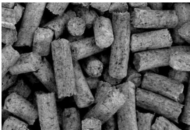
Złej jakości pelet drzewny - ciemny z korą (z czarnymi kropkami)
