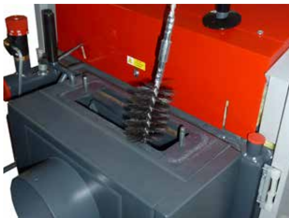
Czyszczenie pionowego kanału spalinowego poprzez wieczko górne przy pomocy szczotki.
