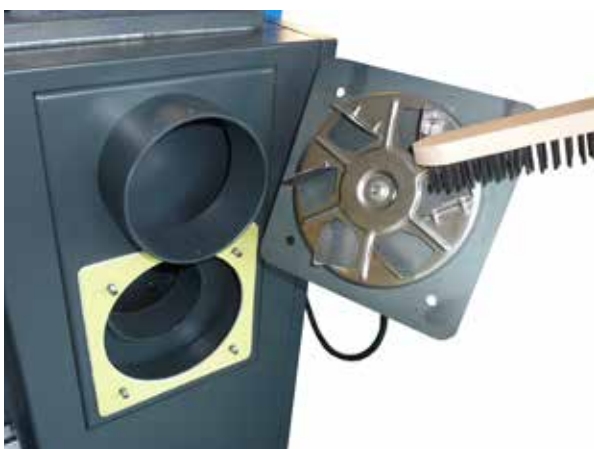
Oczyszczanie koła obiegowego wentylatora spalinowego - kontrola stanu łopatek
