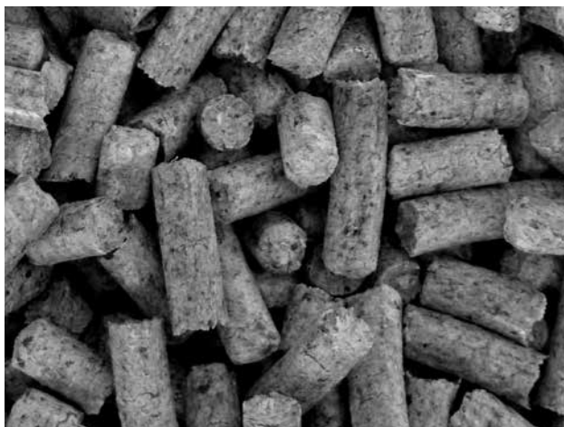
Złej jakości pelety drewniane - ciemne z korą (z czarnymi kropkami)
