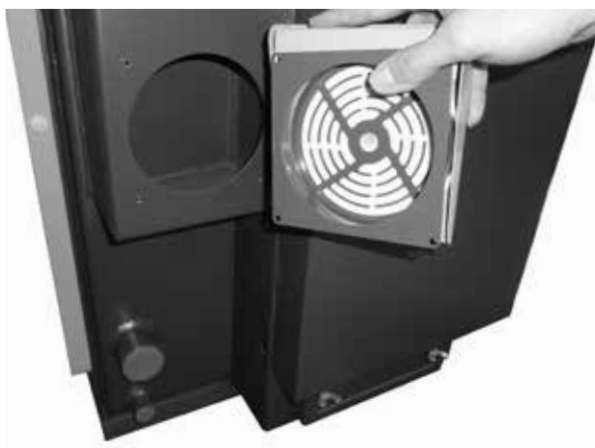
Kontrola i oczyszczanie kanału powietrznego wyposażonego w klapę regulacyjną
