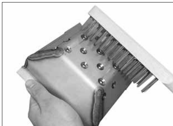
Ilustracja czyszczenia komory spalania
