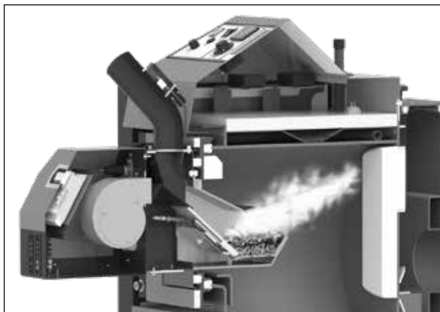
Płomień palnika kończy się 1 - 3 cm przed przeciwną ścianą
