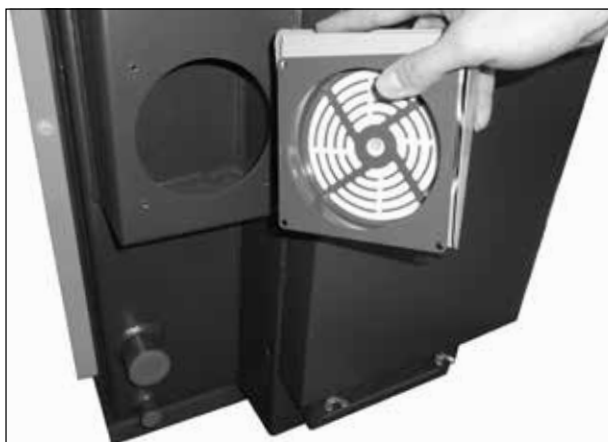
Kontrola i czyszczenie kanału powietrza wyposażonego w zawór regulacyjny
