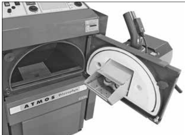
Otwarte górne drzwiczki kotła podczas czyszczenia komory spalania palnika
