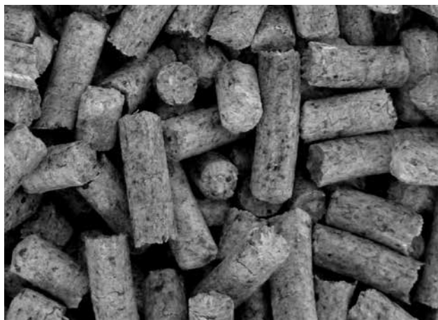
Złej jakości pelet drzewny - ciemny z korą (z czarnymi kropkami)
