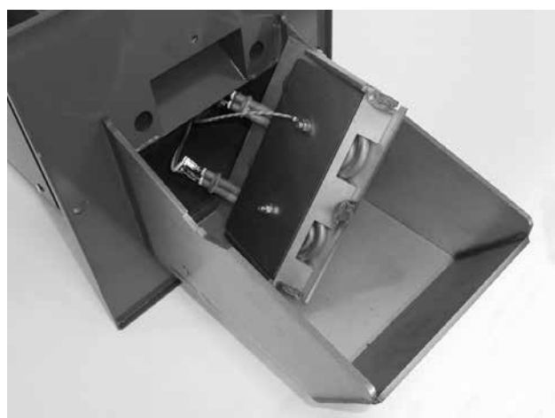
Rys. 4 - Zdemonstrowana pokrywa z grzałkami rozpalającymi
