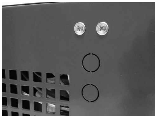
Rys. 11 - zaślepiione otwory dla czujników TS i TV (mogą zostać użyte do innych zastosowań)
