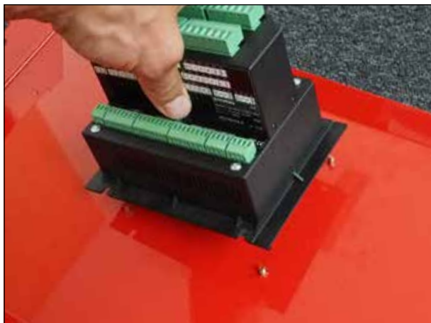
Umieszczenie regulatora na cztery śruby M4
