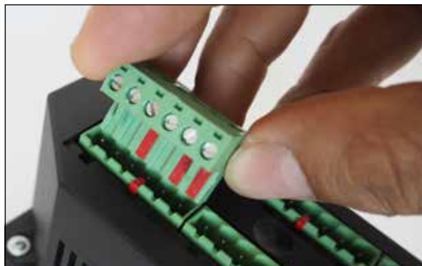
Uwaga – złącza wyposażone są w piny zapobiegające ich zamianie na listwie
